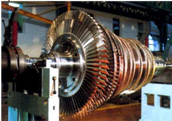
Fig. 7 Rotor de turbine à vapeur industrielle (doc. THERMODYN)
