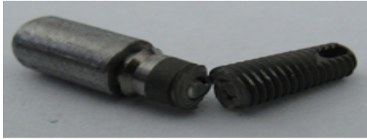
Fig.7. Specimene rupte în timpul testelor la oboseala
