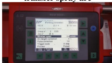
Fig.6.3 Parametrii de sudare la sudarea in curent pulsat
