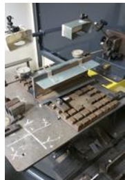
Fig. 8.5 Dispozitive magnetice de orientare și fixare
