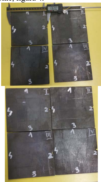
Fig. 4. Placi trasate pentru depunere
