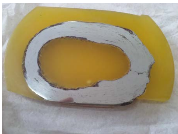
Fig. 2. Za de lanț debitată longitudinal și înglobată în rasina fenolica.
