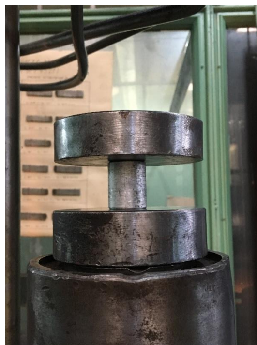
Fig. 7 Pozitionarea piesei in vederea deformarii plastice pe presa
