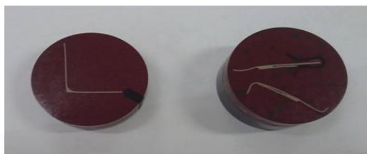
Fig 6. Probe înglobate în rășina fenolică.
