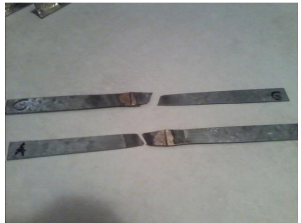
Fig. 5. Probe brazate după încercarea de rupere.
