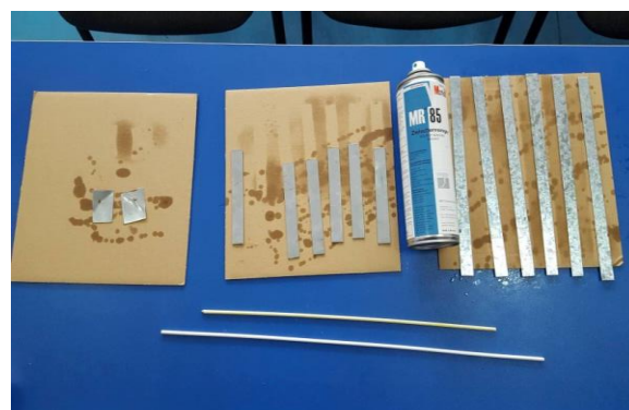
Fig. 2. Pregătirea probelor pentru brazare.
