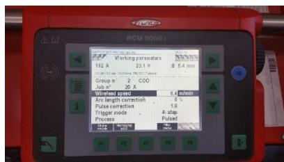
Fig.4.3 Parametrii de sudare la sudarea in curent pulsat
