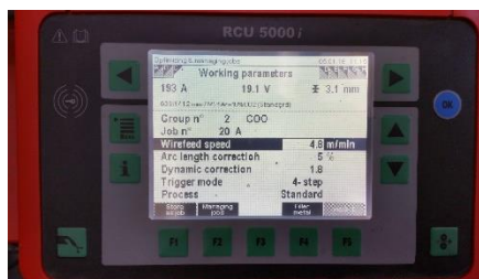
Fig. 4.1 Parametrii de sudare pentru modul de transfer short arc
