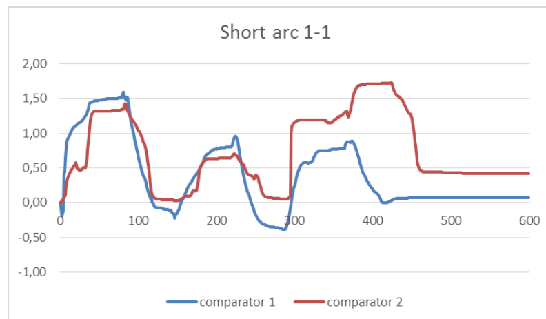
Fig. 4.24 Graficul de deplasare ale piesei pentru modul de transfer short arc pentru ordinea de sudare 1-1
