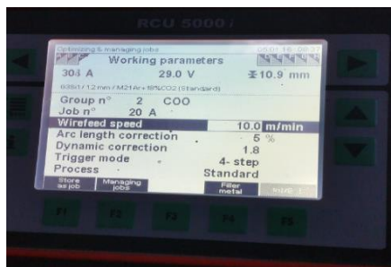
Fig. 4.2 Parametrii de sudare pentru modul de transfer spray arc
