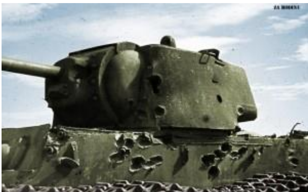
Fig. 1 Urme de lovituri antitanc, unele nepenetrând blindajul
