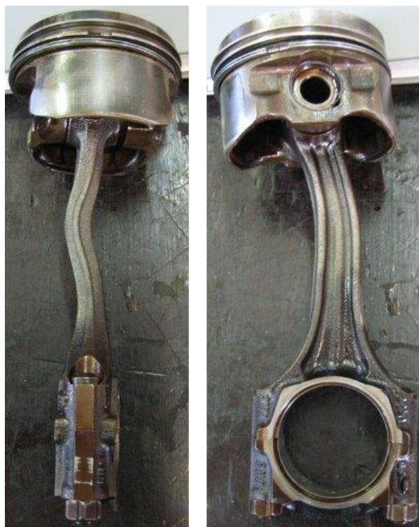
Figura 3 Deformarea bieiei din cauza pătrunderii lichidului de răcire în cilindri (blocaj hidraulic) [6]
