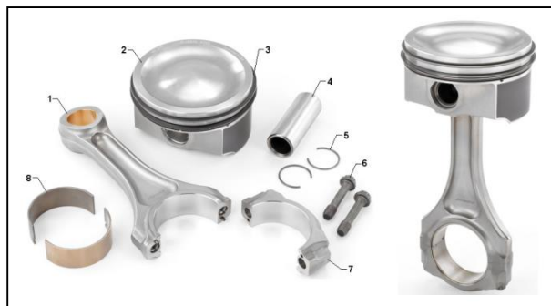
Figura 2 Componentele mobile ale unui motor V8 de 6200 cm 3 (Chevrolet Corvette) [6]
