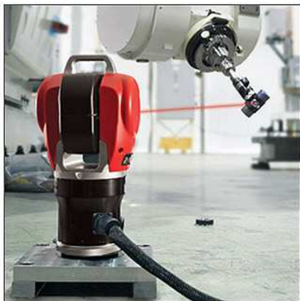
Fig. 3. LaserTraker API Radian în timp ce parcurge o procedură de calibrare
