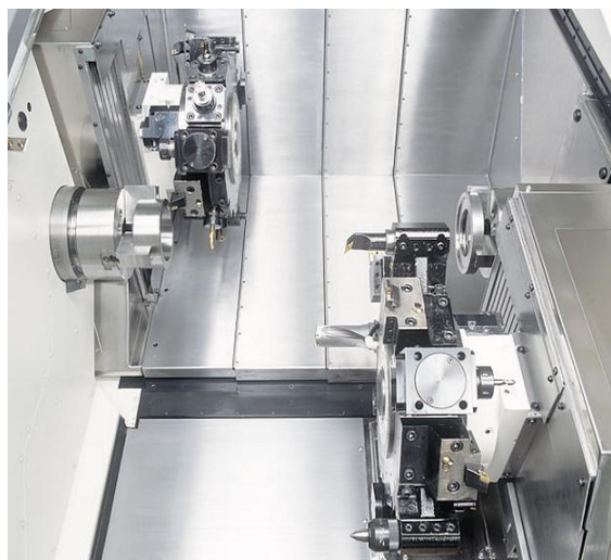
Fig.7 Sistemul 2S al strungului WT-300
